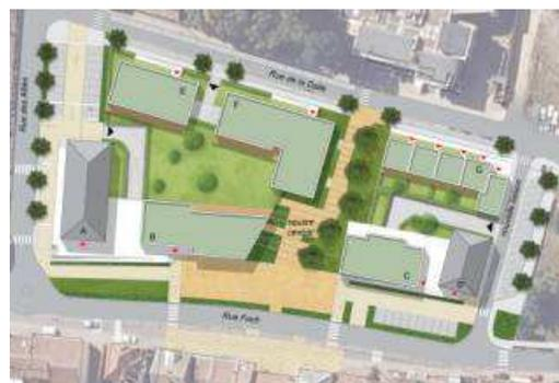
Pour limiter l'imperméabilisation, des sols en pleine terre ou en matériau poreux ont été maintenus au cœur des constructions. Les bâtiments seront dotés de toitures végétalisées et de systèmes de stockage des eaux de pluies. Enfin un réseau d'assainissement des eaux pluviales a été intégré au projet.
