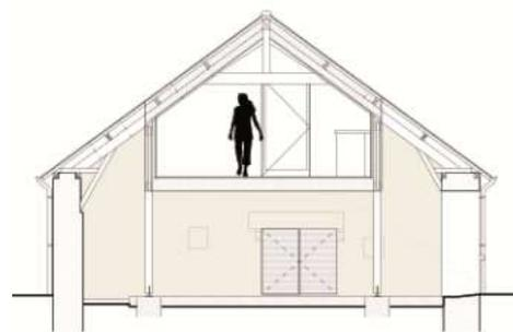
La cabane partage la toiture de la grange et utilise les deux ouvertures de celle-ci afin de recevoir de la lumière naturelle. Une dalle en béton se glisse sous la boîte pour créer un sol.
